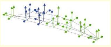
Bild 5. Instrumentierung für die Modalanalyse. Blau: Referenzen, grün: Rover.
