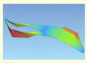
Bild 8d. Form der vierten Eigenschwingung der Brücke. f = 4,86 Hz,  $\zeta$  = 0,24 %.
