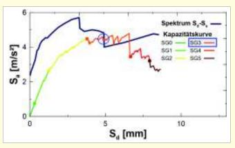
Bild 6. Beispiel zur Ermittlung des Schadensgrades für eine der Simulationsvarianten (am Beispiel des Gebäudes nach Bild 5a)
