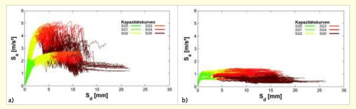
Bild 5. Kapazitätskurven von Beispielgebäuden (hier: Typ "HBD 2 Etagen") [Hinweis: Die Auswertung erfolgt gemäß dem Schema in Bild 6]
