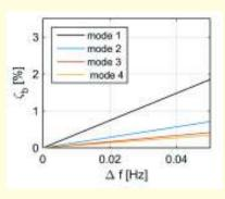
Bild 14. Verzerrung der Dämpfung in Funktion der Frequenzauflösung  $\Delta f$ , wie sie sich aus der Theorie ergibt.
