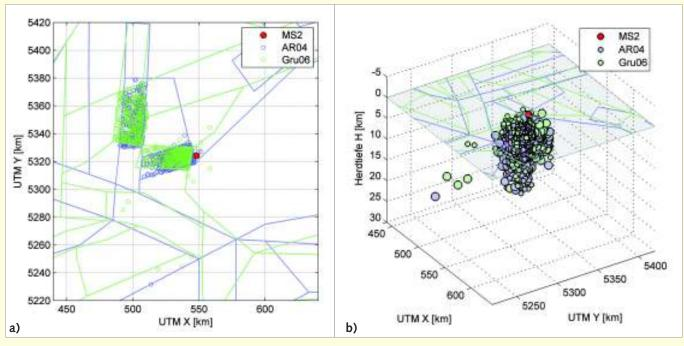
Bild 4. Simulierte Erdbebenbibliotheken für den Katalog EKDAG überlagert mit den Modellen AR04 und Gru06 für den Modellstandort MS2 (multi model) und eine mittlere Wiederkehrperiode von T<sub>R</sub> = 475 Jahren
