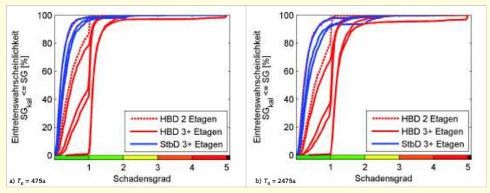
Bild 10. Vergleich der Schadensprognosen von Mauerwerks-Bestandsgebäuden unter Zulassung der Streuung aller Modul-Parameter für Modellstandort MS 4 (Tabelle 1)
