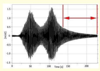
Bild 10b. Zweite Eigenschwingung, f = 2.24 Hz,  $\zeta$  = 0,15 %
