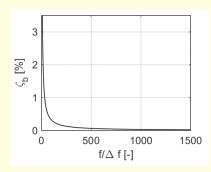
Bild 16. Verzerrung der Dämpfung in Funktion des Verhältnisses f $1/\Delta f$ .
