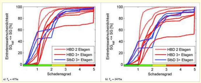
Bild 9. Vergleich der Schadensprognosen von Mauerwerks-Bestandsgebäuden unter Zulassung der Streuung aller Modul-Parameter: Modellstandort MS1 (Tabelle 1)
