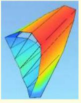
Bild 8a. Form der Grundschwingung der Brücke. f = 0.85 Hz,  $\zeta = 0.83 \%$ .
