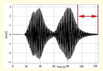
Bild 10c. Dritte Eigenschwingung, f = 3,85 Hz,  $\zeta$  = 0,40 %
