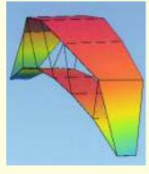
Bild 8c. Form der dritten Eigenschwingung der Brücke. f = 3.85 Hz,  $\zeta = 0.77$  %.
