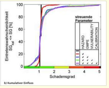
Bild 7. Einfluss der Streuung der Parameter für Modellstandort MS2 unter Verwendung des Katalogs EKDAG und des Modells Gru06 für T<sub>R</sub> = 475 Jahre: Beispielgebäude nach Bild 5a
