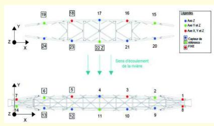
Bild 3. Messpunktraster für die Modalanalyse. Unten: Fahrbahn, oben: Bogen.
