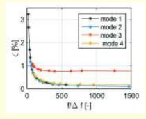
Bild 15. Dämpfung in Funktion des Verhältnisses fn/ $\Delta f$ .
