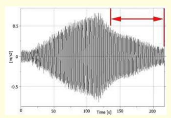
Bild 10a. Erste Eigenschwingung, f = 0,85 Hz,  $\zeta$  = 0,29 %
