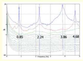
Bild 7. Die vier tiefsten Eigenfrequenzen der Brücke im SVD-Diagramm.
