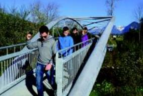
Fig. 9b. Die Schrittfrequenz wurde jeweils mittels eines mitgeführten Metronoms vorgegeben.
