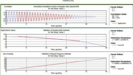
Bild 12. Von oben nach unten: SVD-Diagramm, Korrelationsfunktion, Fit des Dämpfungswertes, Fit des Frequenzwertes.
