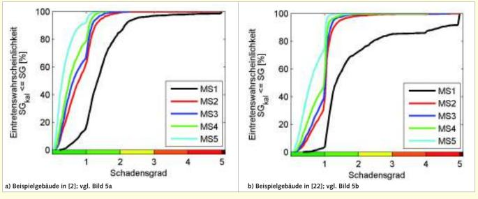
Bild 8. Vergleich der Schadensprognosen unter Zulassung der Streuung aller Modul-Parameter für T<sub>p</sub> = 475 Jahre
