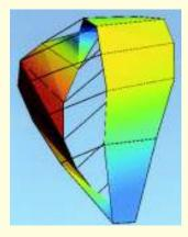
Bild 8b. Form der zweiten Eigenschwingung der Brücke. f = 2.24 Hz,  $\zeta$  = 0.34 %.
