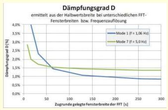
Bild 11. Je kürzer das für die Fouriertransformation benützte Zeitfenster, desto höher der Dämpfungskoeffizient (Bild aus [5]).
