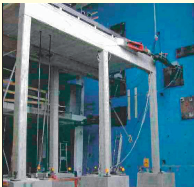
Bild 8. Großversuch am Stahlbetonrahmentragwerk [15]
