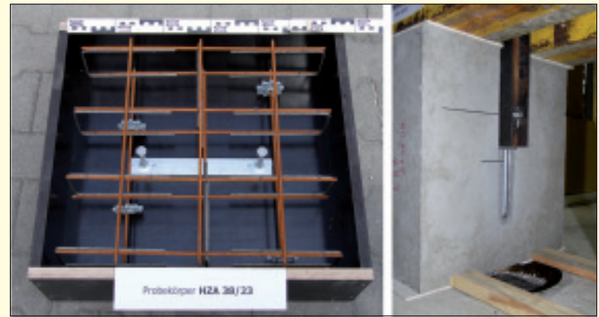
Bild 4. Schaltung und Bewehrung des Probekörpers der HZA 38/23 Ankerschiene (links) und dessen Einbauzustand in der Versuchsvorrichtung (rechts)
