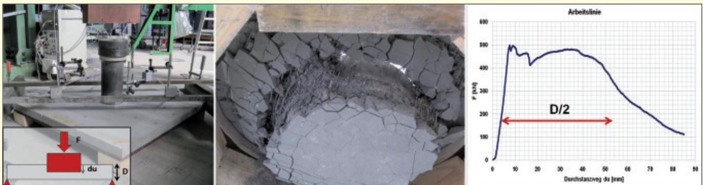
Bild 4. Duktiles Durchstanzverhalten, Duktilitätsgrad > 10
