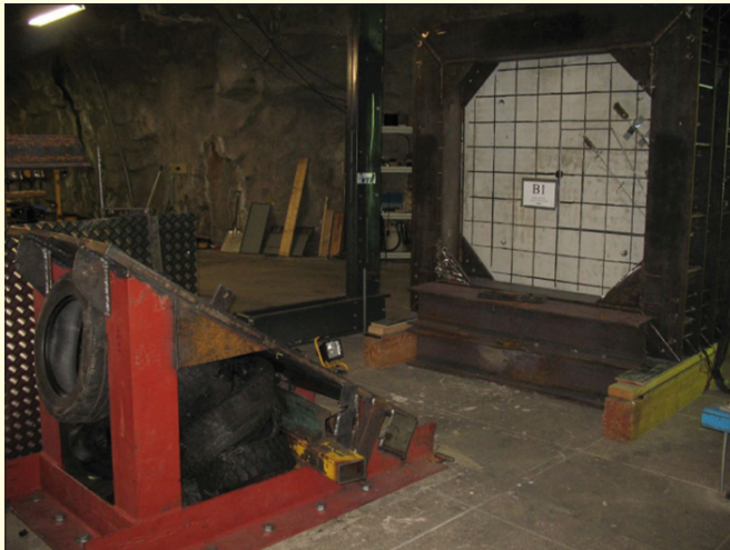
Bild 2. Darstellung der Stahlbetonplatte mit Abfangbock [1]
