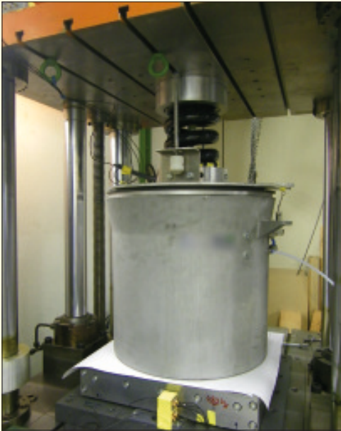
Bild 7. Im Federprüfstand von Müller-BBM eingebautes Luftfederelement.
