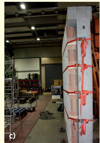
Bild 17. Schadensbild der Ausfachung (a), Versagen der Mauersteine am Wandkopf (b) und Kippbewegung der Ausfachung nach Abschluss des Versuchs (c)
