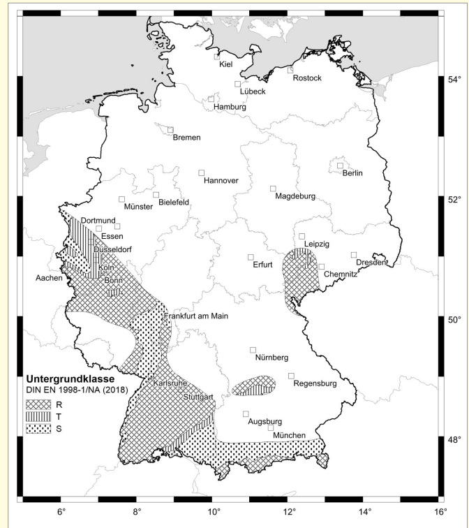
Bild 4. Karte der Geologischen Untergrundklassen nach [11], angepasst an die Konturlinie S_{ap,R} = 0,6 \text{ m/s}^2 (vgl. Bild 3b)
