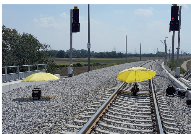
Bild 11. Aufstellung der beiden Long Stroke Shaker in Gleisachse (Messposition 1) und auf den Randbalken (Messposition 2)
