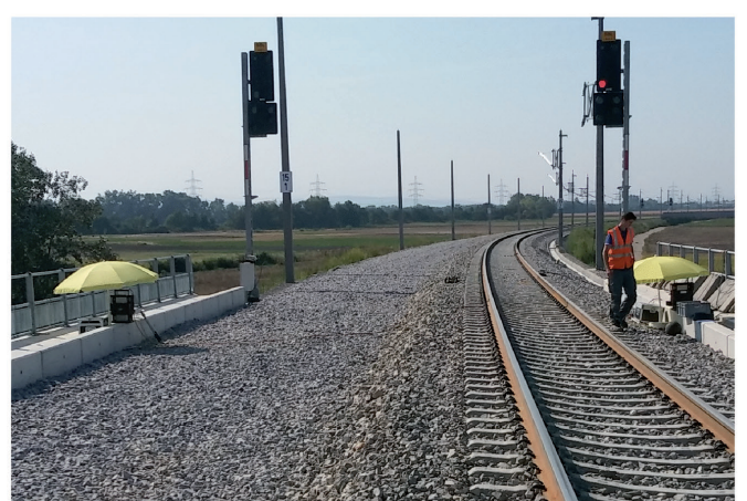
Bild 11. Aufstellung der beiden Long Stroke Shaker in Gleisachse (Messposition 1) und auf den Randbalken (Messposition 2)
