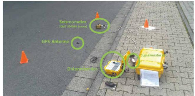
**Bild 4.** Aufbau einer Messstation. Der Sensor steht etwa zwei Meter vom Datenrekorder und dem Transportkoffer entfernt. Das GPS-Signal liefert genaue Informationen über die Messpunktposition und den Messzeitraum. Abb.: HLNUG
